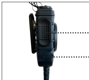
seitliche PTT 3,5 mm Klinkenbuchse zum Anschluss vom Ohrhörern
