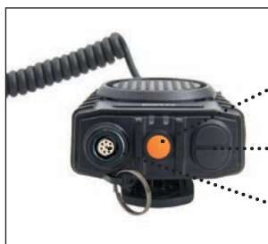
Notruftaste (optional) zwei Tasten zum Ein- oder Abschalten des Situationsbewusstseins ODU Headset Anschluss
