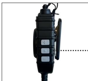
Lautstärkereger +/- und Stummtaste, wenn das Headset angeschlossen ist
