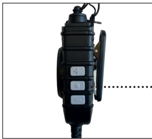
Lautstärkereger +/- und Mikrofon oder Lautsprecher- Stummtaste
